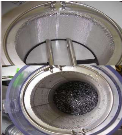
<Bên trong bộ lọc khử nước thải>
