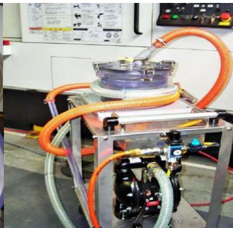
<現場で活躍中のスラッジバキューマー>
